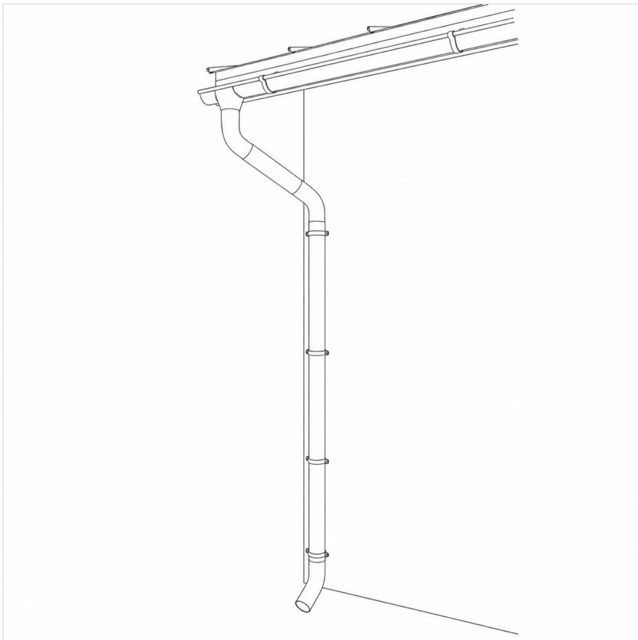
18. solis. Vertikālās notekcaurules garuma noteikšana
