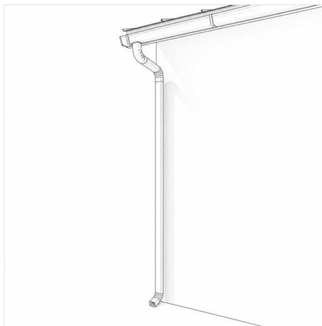
14. solis. Vertikālās notekcaurules izvietojums
